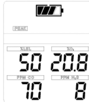
Figura 3-10. Lecturas del valor máximo en pantalla.
