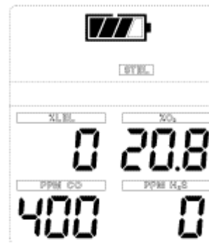
Figure 3-12. Ecran d'exposition en cas d'alarme STEL
