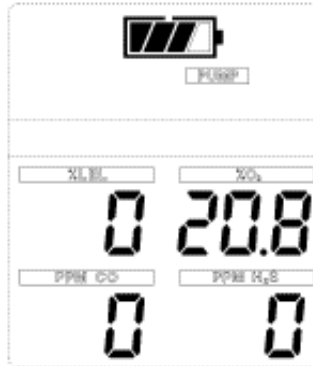
Figure 3-3. Alarme de pompe
