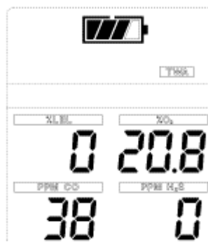
Figure 3-13. Ecran d'exposition en cas d'alarme TWA
