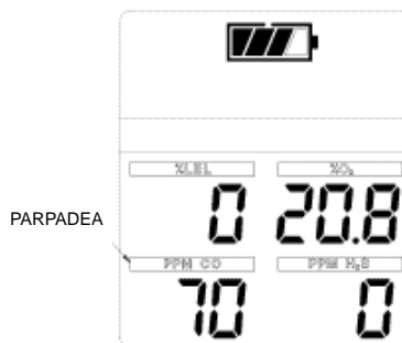
Figura 3-8. Instrumento en alarma de gas tóxico
