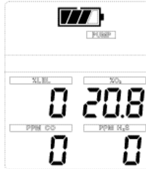
Figura 3-3. Alarma de la bomba mostrada en pantalla
